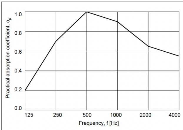
Figura 1: Prueba de sonido montada con 45mm de aislamiento detrás del panel. Marco cerrado alrededor del borde.
