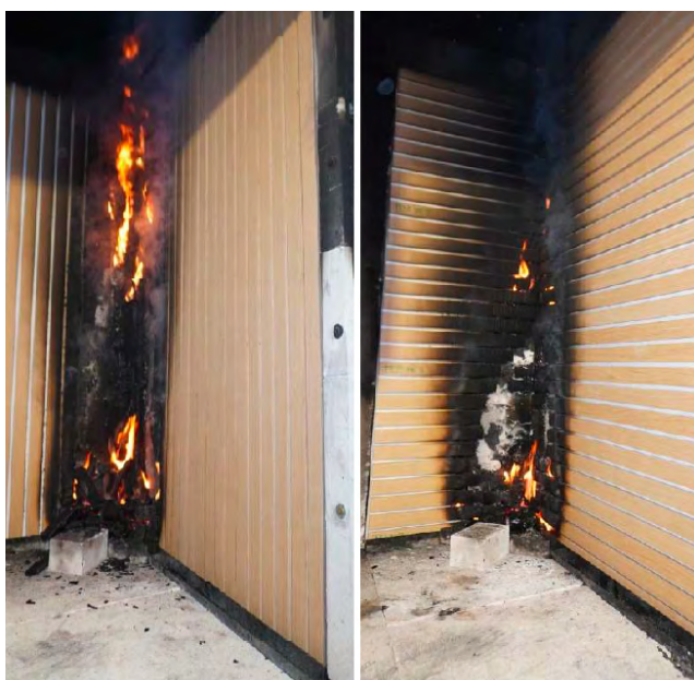
Figura 2: Campioni (N° 8784-1-3 e 8784-1-7) dopo il test.
