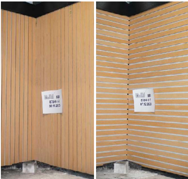
Figure 1 : Montage d'essai à SBI – Orientation verticale et horizontale des lamelles.
