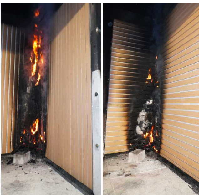
Figura 2: Campioni (N° 8784-1-3 e 8784-1-7) dopo il test.
