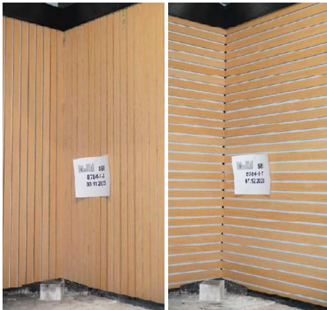
Rysunek 1: Montaż próbny w SBI – Pionowa i pozioma orientacja listew.
